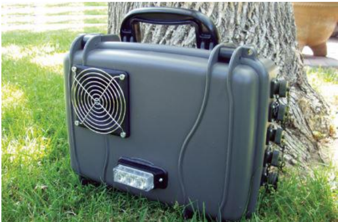
სურათი 3. „ScareCall“ - სინათლისა და ხმის მოწყობილობა
